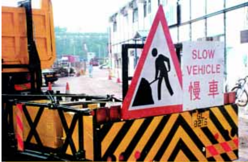
防撞車架(一種撞擊力衰減器) Truck mounted attenuator
